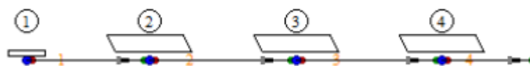
Figura 4: Fluxograma de processo de tratamento da ETE Capitão Mor usado no WATER9. 1 tubulação de entrada, 2 Lagoa Facultativa, 3 e 4 Lagoas de maturação.
